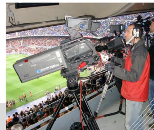
La posición de las cámaras máster deberá permitir abrir el plano de forma que se pueda seguir el juego sin interferencias arquitectónicas y se pueda ver la grada opuesta completamente
