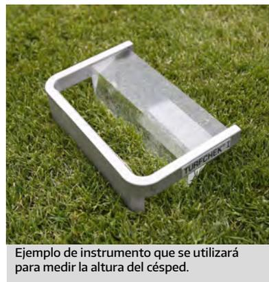
Ejemplo de instrumento que se utilizará para medir la altura del césped.
